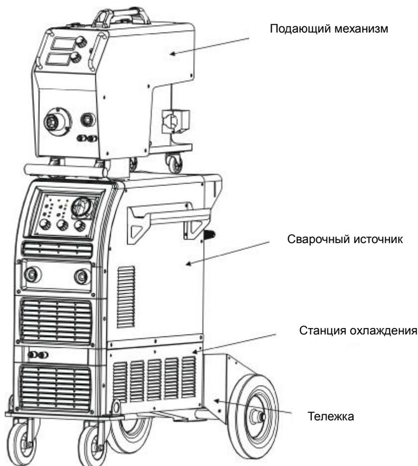
При сборке оборудования следуйте следующим рекомендациям:
