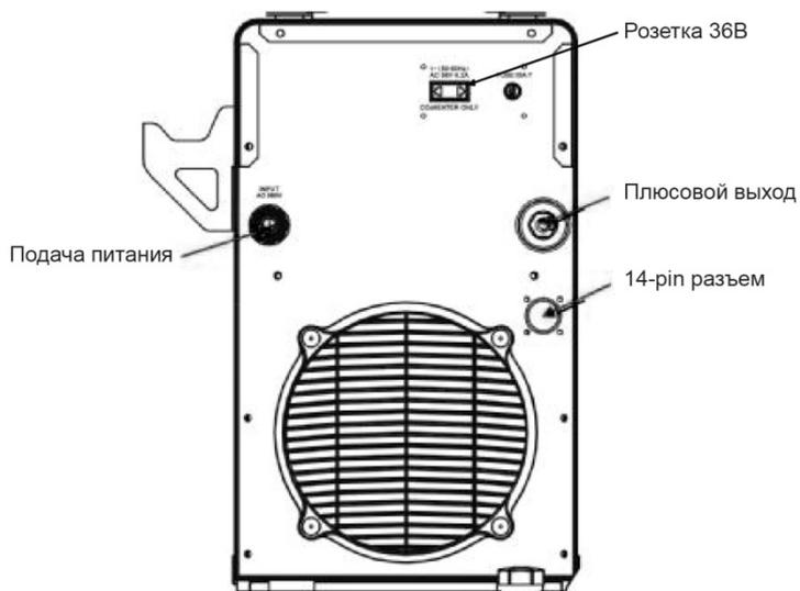
**Задняя панель станции охлаждения:**
