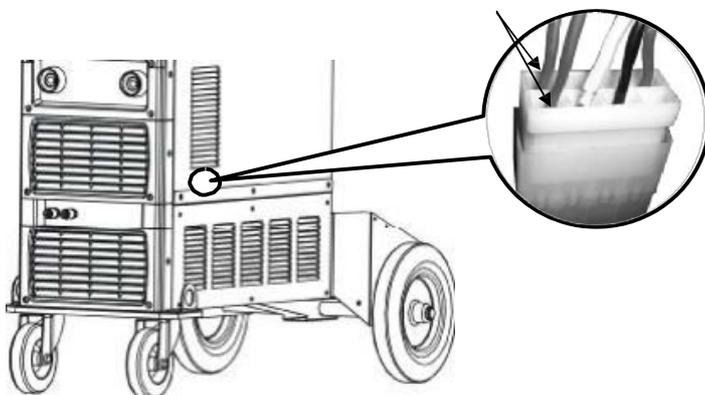
Нажмите курок сварочной горелки, станция начнёт работать. Затем отсоедините левую трубку станции, выпускайте воздух.
