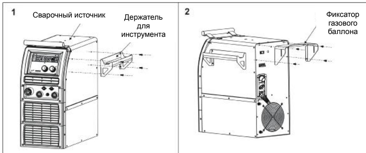
3. Если аппарат используется без станции охлаждения, закрепите передние колеса и заднюю площадку газового баллона при помощи болтов М6.
