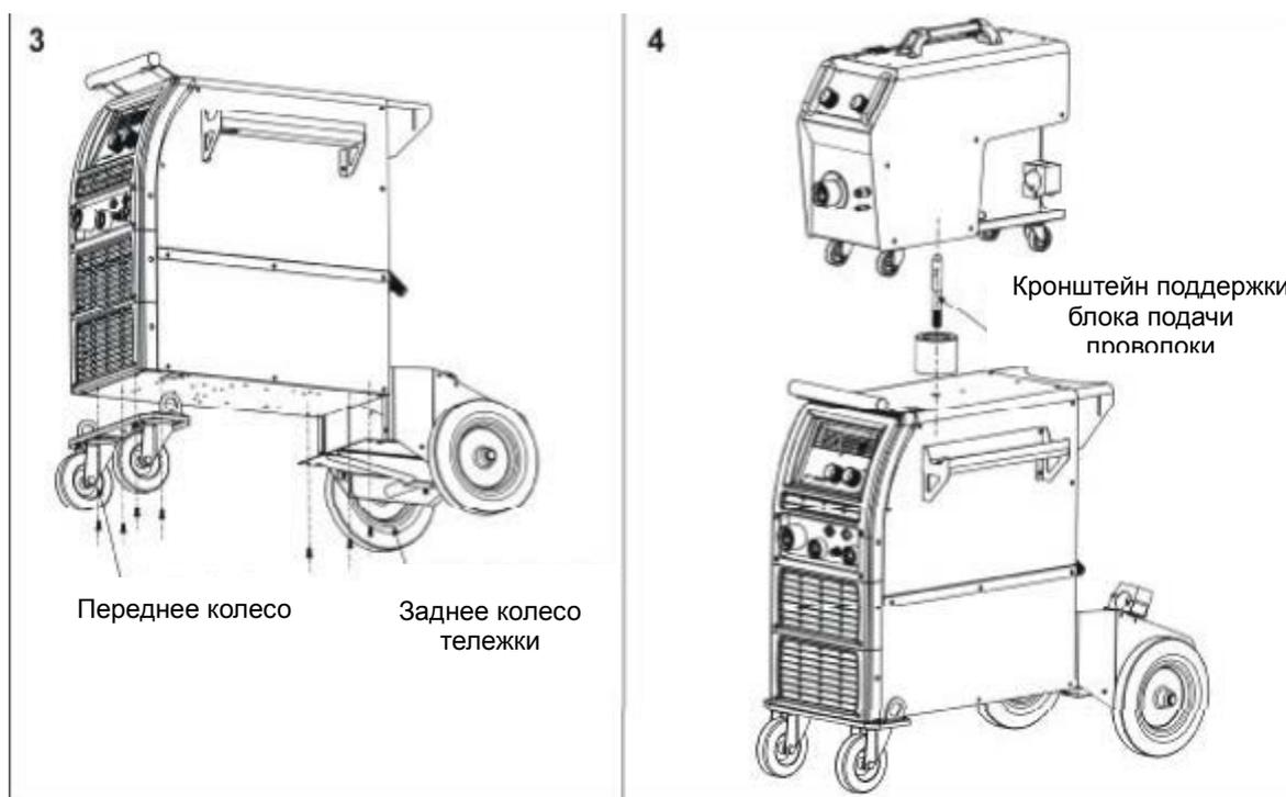
5. Если вы используете станцию охлаждения, закрепите передние колеса и заднюю площадку газового баллона к днищу станции охлаждения при помощи болтов М6.
